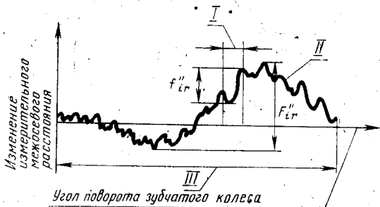
I — один угловой шаг; II — кривая изменения измерительного межосевого расстояния; III — один оборот зубчатого колеса.
